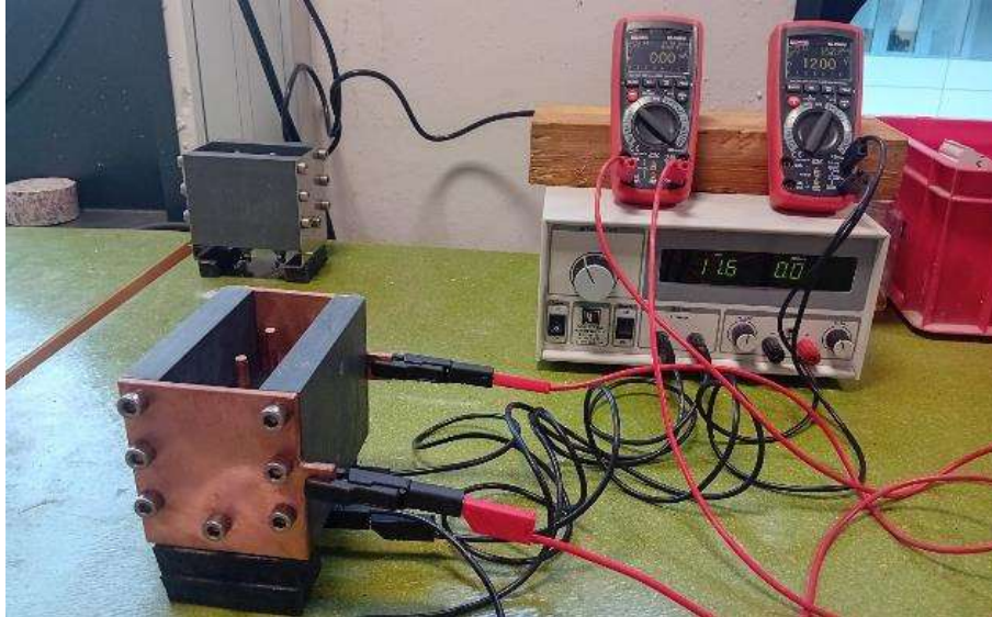
Foto 5 Meten van waterabsorptie gebaseerd op elektrische geleidbaarheid
